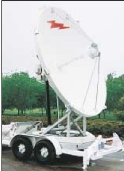
3.7-Meter Transportable Antenna
